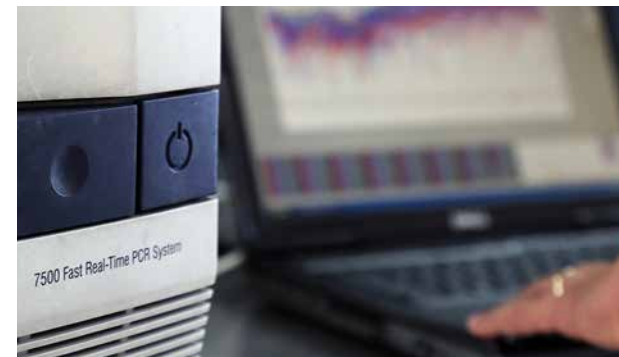
PCR-Gerät zur Vervielfältigung von DNS für die anschliessende molekulare mikrobiologische Diagnose (© Pan American Health Organization PAHO)
